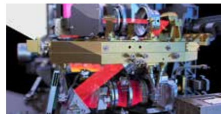
Het pad dat licht volgt in het Tropomi instrument met behulp van de vrijgevormde optica. Paars is UV, rood staat voor nabij infrarood, geel is licht in de voor mensen zichtbare golflengten.
